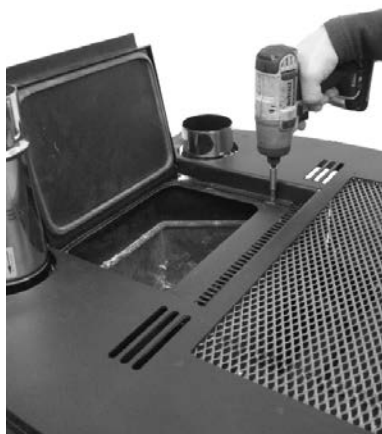
Fig. 41 - Αφαίρεση άνω βιδών
