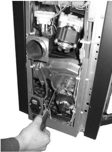
Fig. 104 - Καθαρισμό ανεμιστήρα καυσαερίων : Φάση 1
