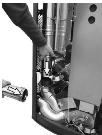
Fig. 63 - Τοποθέτηση σωλήνων για τη διοχέτευση
