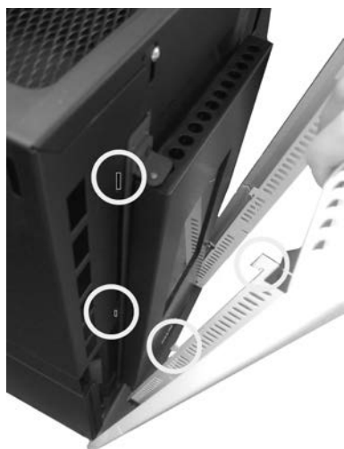
Fig. 30 - Τοποθέτηση μπροστινού πάνελ
