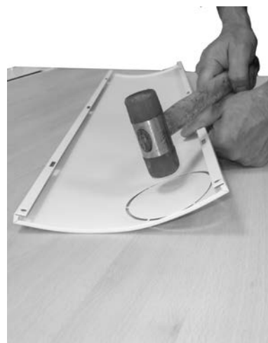
Fig. 38 - Ανοίξτε την τρύπα (μοντέλο Sfera 3 Plus)
