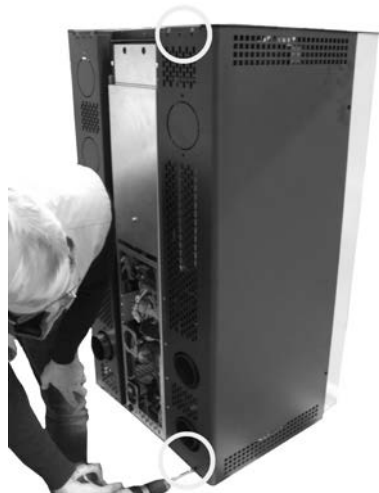
Fig. 94 - Αφαίρεση πίσω βιδών
