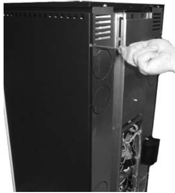
Fig. 76 - Αφαιρέστε την πίσω βίδα
