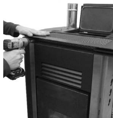
Fig. 43 - Αφαίρεση εμπρός βιδών
