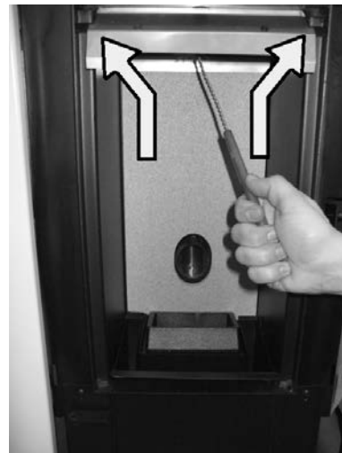
Fig. 98 - Καθαρισμός καναλιού καυσαερίων
