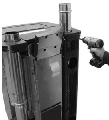
Fig. 42 - Αφαίρεση πίσω βιδών
