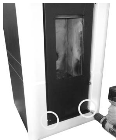
Fig. 32 - Στερέωση Μπροστινού Πάνελ
