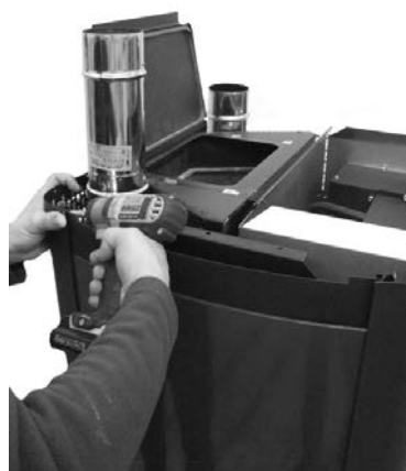
Fig. 47 - Επανατοποθετήστε τα άνω καμπυλωτά προφίλ
