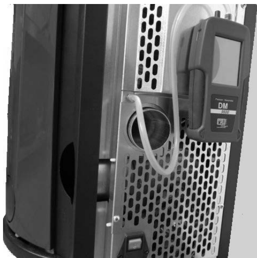
Fig. 55 - Σύνδεση ψηφιακού πρεσοστάτη
