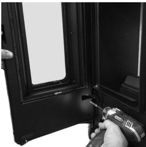
Fig. 85 - Χαλαρώστε τις βίδες
