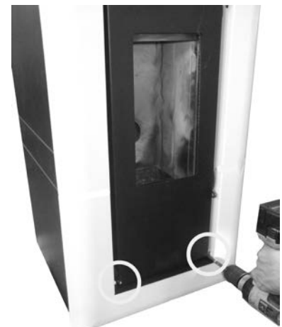
Fig. 26 - Στερέωση Μπροστινού Πάνελ
