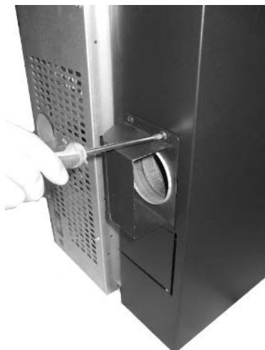
Fig. 69 - Σύνδεση διαχυτή
