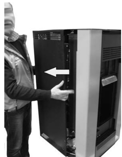
Fig. 95 - Αφαίρεση πλευρών
