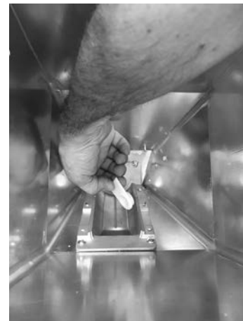
Fig. 74 - Αφαίρεση ρουλεμάν
