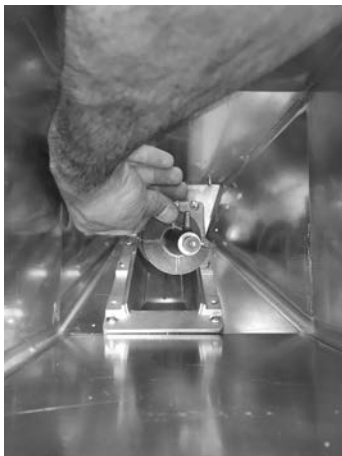
Fig. 73 - Αφαίρεση σπείρας
