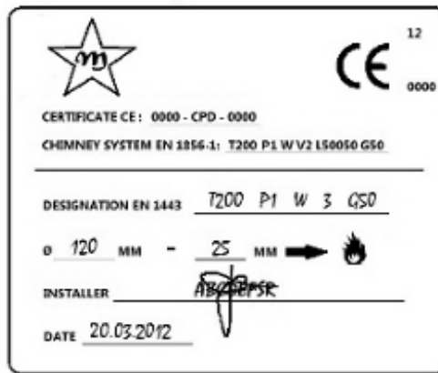
Fig. 4 - Παράδειγμα Ετικέτας
